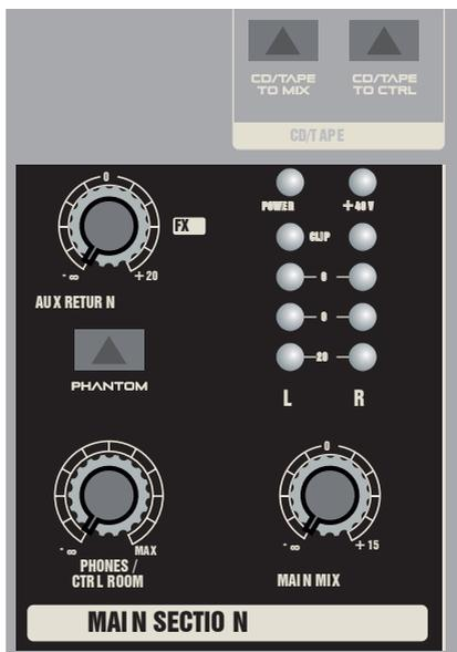
Fig. 2.4: Elementi di controllo della sezione principale
